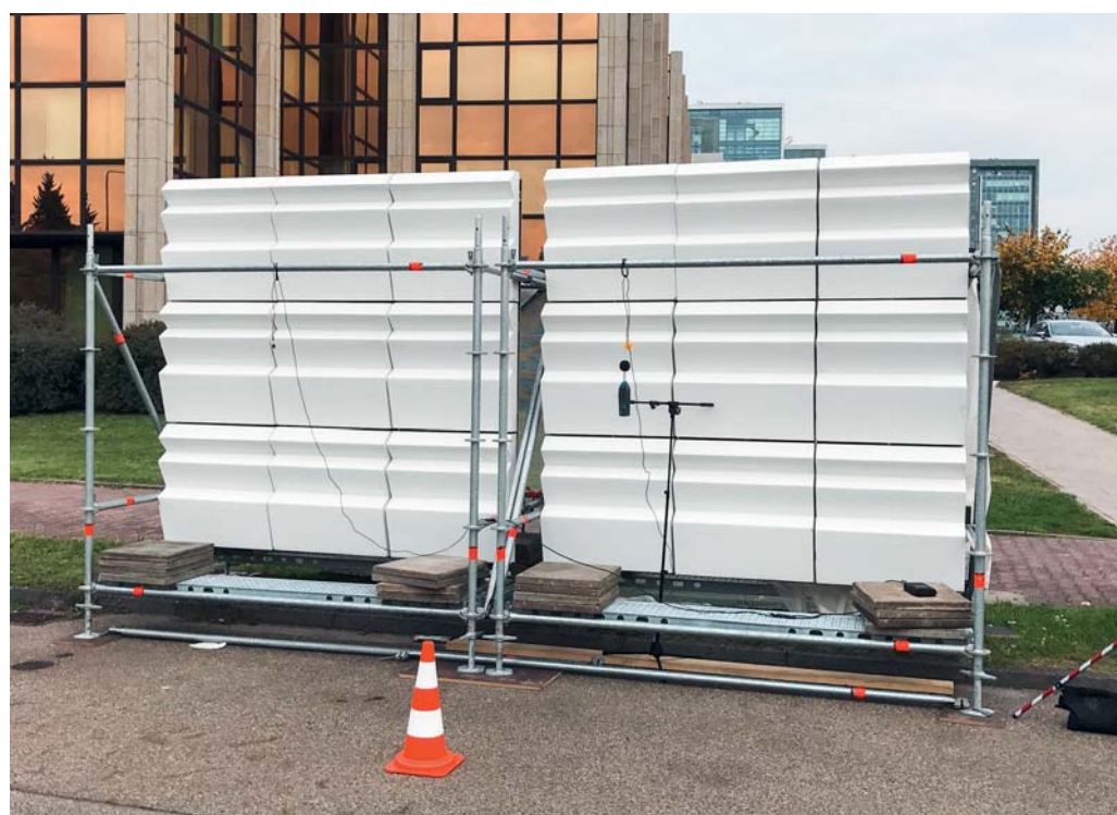
WDVS-Testfassade in Einbaulage «Grosse Fläche unten (GFU)».
